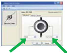
3. Entscheiden Sie, welche der zwei Soft-Tasten Sie zur Steuerung Ihres Mobiltelefons verwenden möchten. Öffnen Sie die entsprechende Dropdownliste und wählen Sie hier die Option **Mobile [Mobiltelefon]**.
