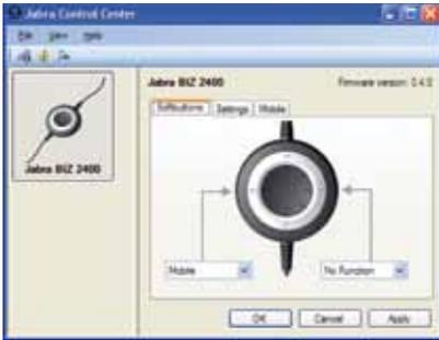
Ist das Headset an Ihren Computer angeschlossen, werden diejenigen Einstellungen angezeigt, die für dieses Headset relevant sind. Diese Einstellungen sind in drei Registerkarten aufgeteilt: **Softbuttons [Soft-Tasten]**, **Settings [Einstellungen]** und **Mobile [Mobiltelefon]** (nur, falls aktiviert). Jede dieser Registerkarten wird untenstehend beschrieben.
